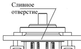
Рисунок 1 - Место положения сливного отверстия
